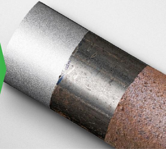
Durch verschiedene Strahlmittel ist vom Polieren bis zu einer Rautiefe von 100 µ alles möglich.
